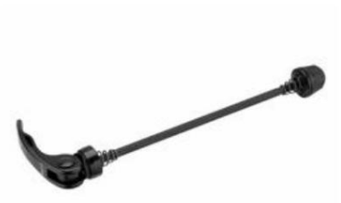
Snelwissel-as (alleen voor niet-elektrische modellen)
